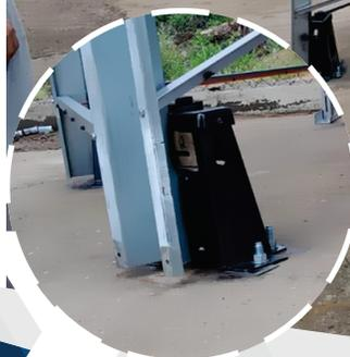
Sistema de Pesagem desenvolvido para transformar um Silo convencional em uma balança;
